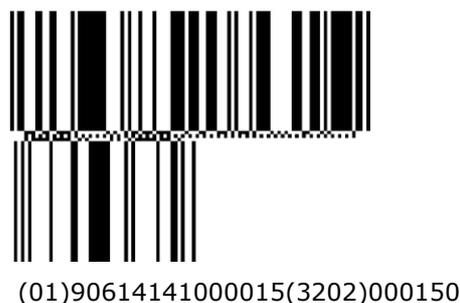
El GS1 DataBar Expandido Apilado se utiliza cuando el área del símbolo o el mecanismo de impresión no es lo suficientemente ancha como para ubicar la totalidad de la única fila del símbolo GS1 DataBar Expandido. Ha sido diseñado para los productos de peso variable, los productos perecederos, los productos minoristas que pueden ser rastreados y los cupones.
