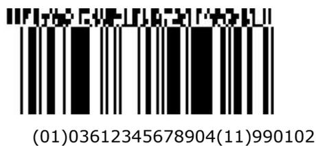
**Figura 5.8.8-6.** Símbolo GS1 DataBar Apilado con CC-A de dos columnas
