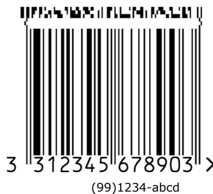
**Figura 5.8.8-2** Símbolo UPC-A con un componente CC-B de cuatro columnas
