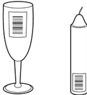
Figura 6-5 Ejemplos de Código de Barras sobre Superficies Cilíndricas
